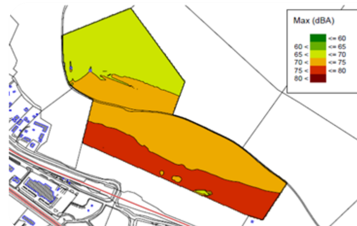
Bild 23 Maximal ljudnivå 2m ovan mark, vilket motsvarar första våningen
