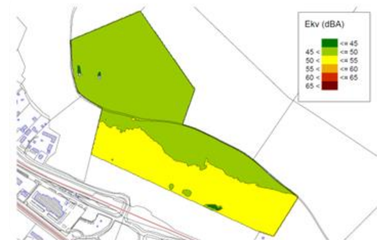
Bild 22 Ekvivalent ljudnivå 2m ovan mark, vilket motsvarar första våningen
