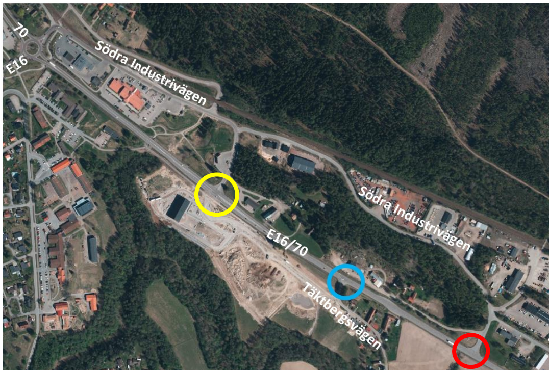
Figur 5. Planerade ombyggnationer. Gul markering redovisar ombyggnation till en permanent cirkulationsplats samt blå och röd markering visar på avstängd korsning.
