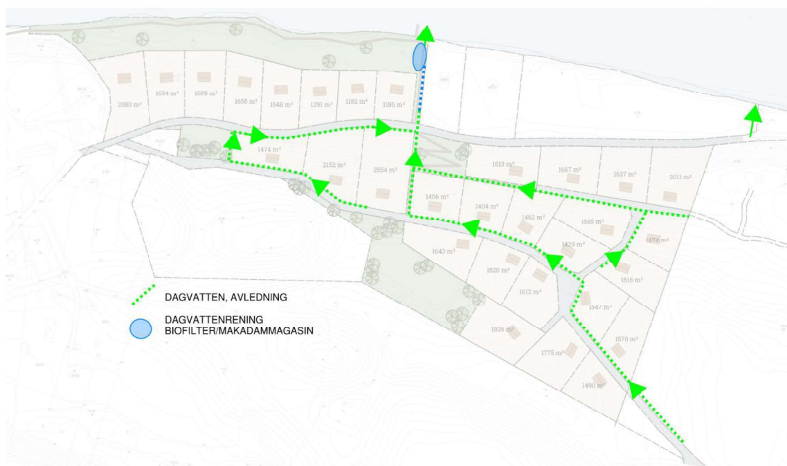
Figur 4-1. Skiss över föreslaget dagvattensystem inom utredningsområdet.
