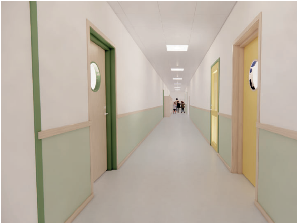
DÖRRAR TILL SKOLANS OLIKA LOKALER FÄRGKODAS FÖR ATT ÖKA ORIENTERBARHETEN. KORRIDORER MED RIKLIG BELYSNING ÖKAR TRYGGHETSKÄNSLAN.
